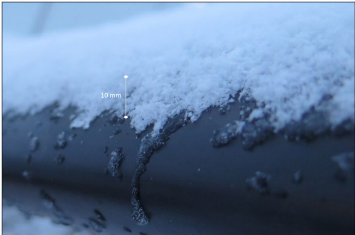
Figure D4. Épave de l'aéronef en cause montrant le phénomène de fonte et regel environ 8 heures après l'événement à l'étude
