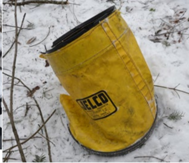
Figure 5. Sac à outils qui s'est détaché du Air Stair et qui se trouvait parmi les débris (Source : BST)
