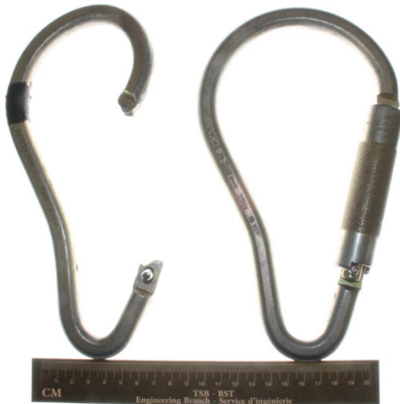
Figure 3. Vue du mousqueton en cause dans l'événement (à gauche) et d'un modèle type (à droite) (Source : BST)
