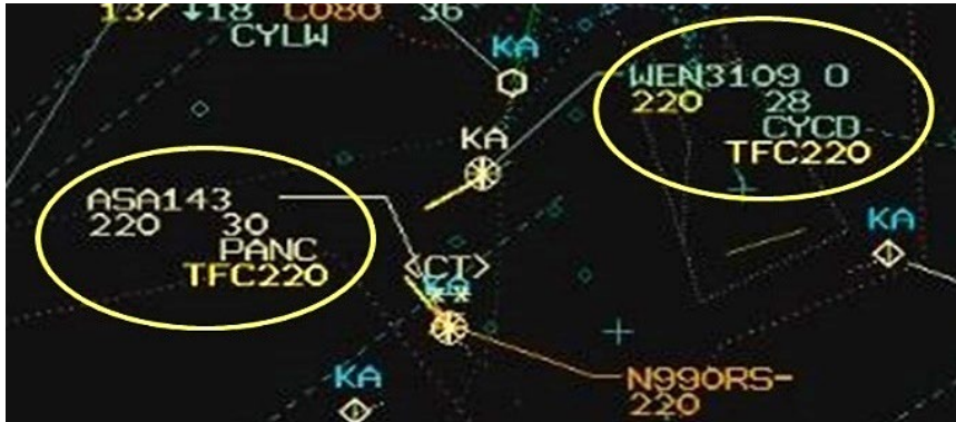
Figure 9. Gros plan de l'affichage de situation du Système canadien automatisé de la circulation aérienne montrant une alerte TFC220 pour le Piaggio (indiqué par ASA143) et le Q400 (WEN3109) (Source : NAV CANADA, avec annotations du BST)
