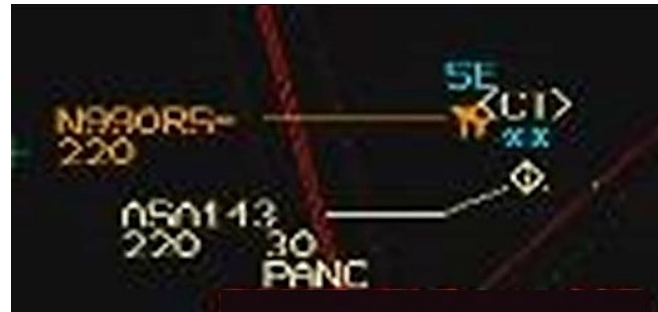
Figure 8. Gros plan de l'affichage de situation du Système canadien automatisé de la circulation aérienne montrant le Piaggio identifié par l'indicatif de vol ASA143, une cible sans corrélation, et la position du Piaggio d'après les données de plan de vol traitées par les processeurs de données de vol du Système canadien automatisé de la circulation aérienne, s'affichant comme une cible non-radar (Source : NAV CANADA)
